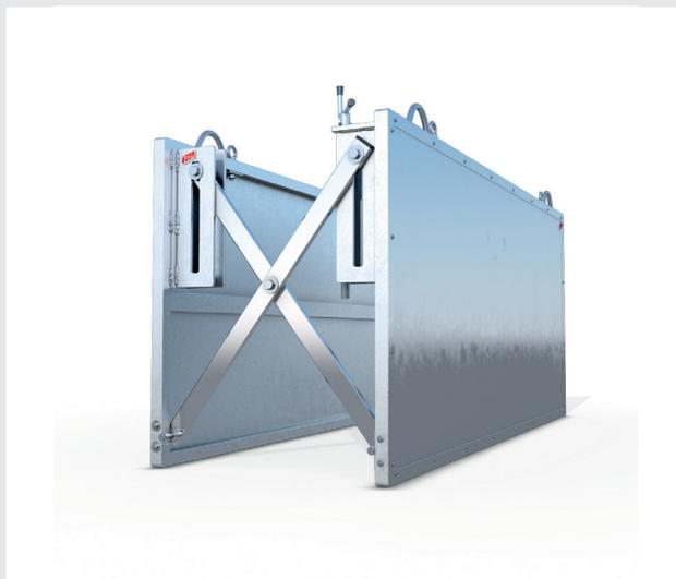
El uso de encofrados previene el riesgo de deslizamiento del terreno dentro de la fosa. La apertura tipo tijera de las dos paredes de contención en aleación de aluminio se regula mediante dos pomos de fácil acceso.
